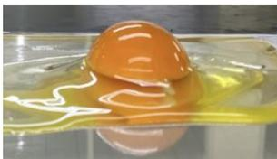
市販食品を対象とした食品の変質・鮮度試験や食品添加物試験、微生物の簡易検査、清浄度試験を行う科目です。卵の鮮度を判定するために、卵を濃度が違う食塩水の中にいれて浮くか、浮かないかで鮮度を判定する比重法を用いて実験をおこないました。濃度の違う食塩水に入れると卵の鮮度が分かるの！？と驚きますよね。鮮度が落ちた古い卵と、鮮度がいい新しい卵がどうなるのかワクワクした実験でした。また卵を割って、黄身と卵白の高さや大きさを定規で測る割卵検査もしました。卵が割れないように慎重に測ったことを思い出します。
